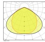
**Technische Daten Ledvance TruSys Performance Rail system 35W 5600lm - 840 | Very Breiter Winkel**
